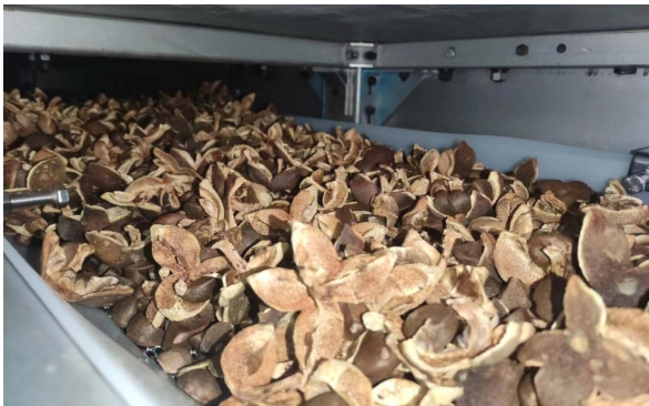
图 6 油茶果干燥应力破蒲中试后的状态
